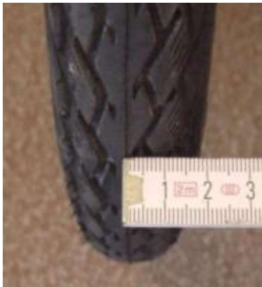
Abbildung 11: Messung der vorderen Mittellinien
