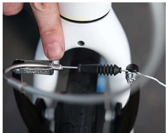
Abbildung 15: richtige Position, Nudel vollständig in der Halterung eingerastet
