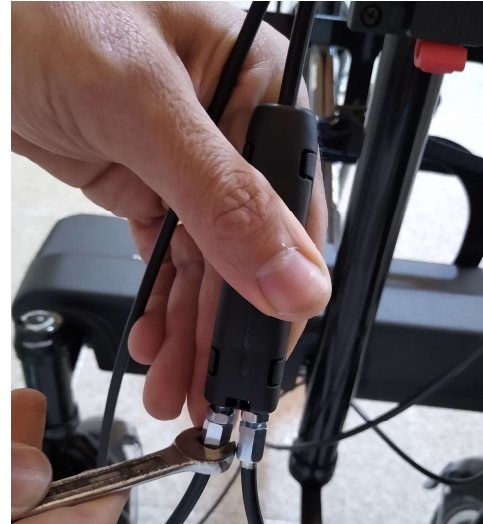
Abbildung 20: Schraube am V-Bremsensplitter
