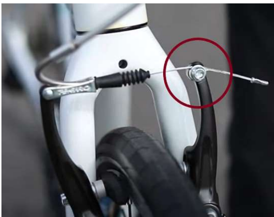
Abbildung 17: Schraube des V-Bremsseils
