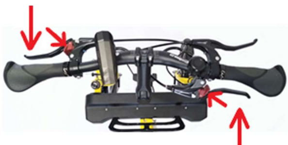
Abbildung 5) EASY PARK-Funktion: TBS-Hebel und Vorderradbremsehebel gedrückt, rote manuelle Parkvorrichtungen eingesetzt
