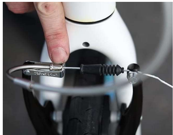
Abbildung 14: Falsche Position, Nudel bleibt an der Kante der Wiege hängen
