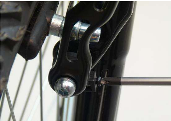
Abbildung 16: Schraube für die Feineinstellung der V-Bremsarme
