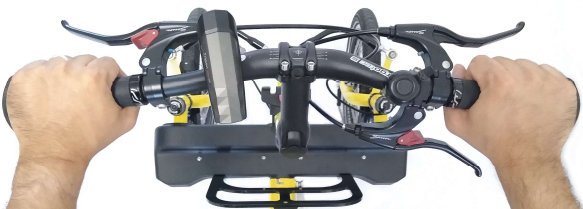
Abbildung 3: EASY STOP-Funktion: TBS-Hebel und Bremshebel gelöst
