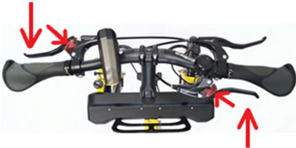
**Figure 5** : Fonction EASY PARK : levier TBS et levier de frein avant actionnés, aide au stationnement rouge engagée
