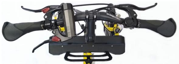
**Figure 2 :** Levier TBS positionné sur le côté gauche du guidon
