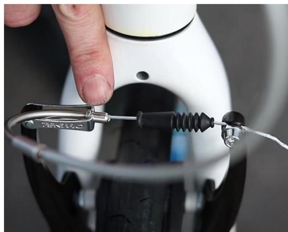
**Figure 15** : Position correcte, raccord entièrement inséré dans le berceau
