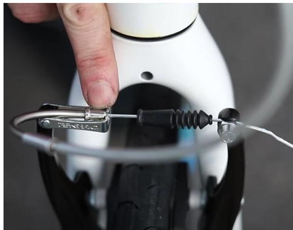
**Figure 14** : Mauvaise position, le raccord est coincé dans le bord du berceau
