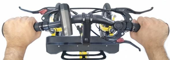
**Figure 3 :** Fonction EASY STOP : levier TBS et levier de frein relâchés
