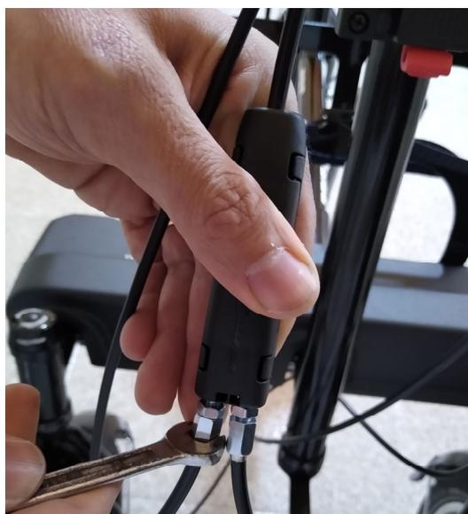
Figure 20 : Vis de réglage du séparateur
