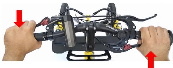
**Figure 4 :** Fonction EASY STOP : le levier TBS et le levier de frein avant sont actionnés simultanément.
