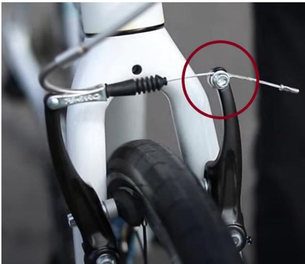
**Figure 17** : Écrou du câble de frein
